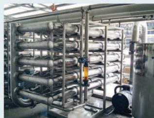
MT膜组件用于发酵液复滤
